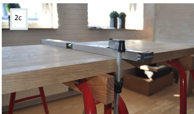
Brug et vaterpas til at lave et land, du kan save efter, og sæt vaterpasset fast på pladen med en skruevinge i hver ende
